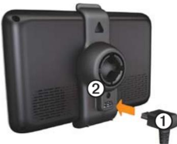
4. Вставьте другой конец кабеля питания от автомобильного источника в разъем прикуривателя автомобиля.
